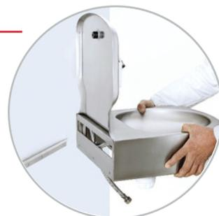
> **Corbeille en retrait** : Ce décrochement permet d'installer le lave-mains sans gêne, quel que soit le volume occupé à l'arrière par les canalisations d'arrivée et d'évacuation d'eau.
