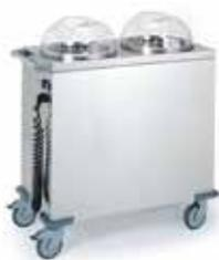
Mise sous tension par un interrupteur marche/arrêt avec voyant. Régulation de la chauffe par un thermostat mécanique réglable de 0°C à 90°C. Chauffage statique assuré par 2 résistances blindées inox disposées sur les côtés. Isolation par laine de verre. Puissance 800 W (1 pile) et 1500 W (2 piles), tension 230 V. Chariots livrés avec couvercles en polycarbonate transparent.
