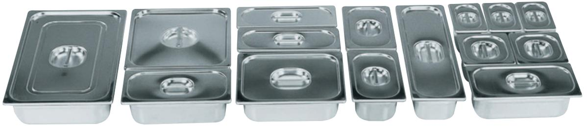
Behälter aus Edelstahl, Stärke: 1 mm bei GN 2/1 und 0,8 mm bei den anderen Modellen. Entspricht der Norm EN 631-1. Sorgfältige Verarbeitung ermöglicht ein homogenes Oberflächenbild. Minimierte Radien, um ein maximales Volumen auf kleinstem Raum zu erreichen. Diese Behälter eignen sich für die Lagerung, Handhabung, Verteilung, das Einfrieren und das Kochen.
